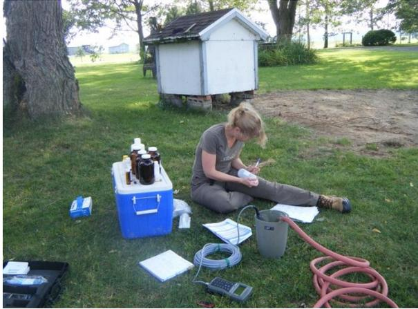
Échantillonnage d'un puits résidentiel à partir d'un robinet extérieur
