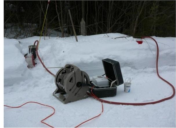
Échantillonnage d'un puits sans pompe
